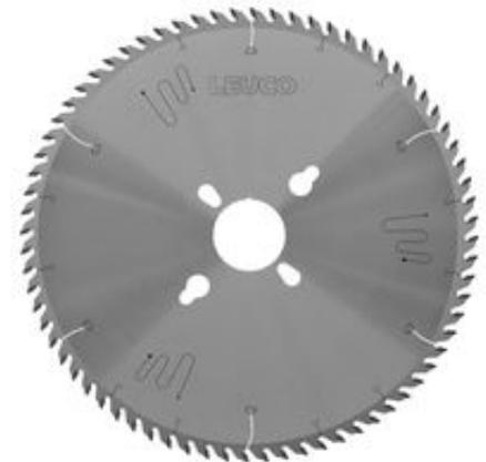
Die empfohlene Schnittgeschwindigkeit liegt bei 70 - 90 m/sec. Bei DP- bestückten Kreissägeblättern ist der obere Wert zu wählen. Es ist ein Vorschub pro Zahn von 0,06 - 0,07 mm anzustreben.
